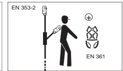
Fall arrest according to EN 353-2/Absturzsicherung nach EN 353-2
